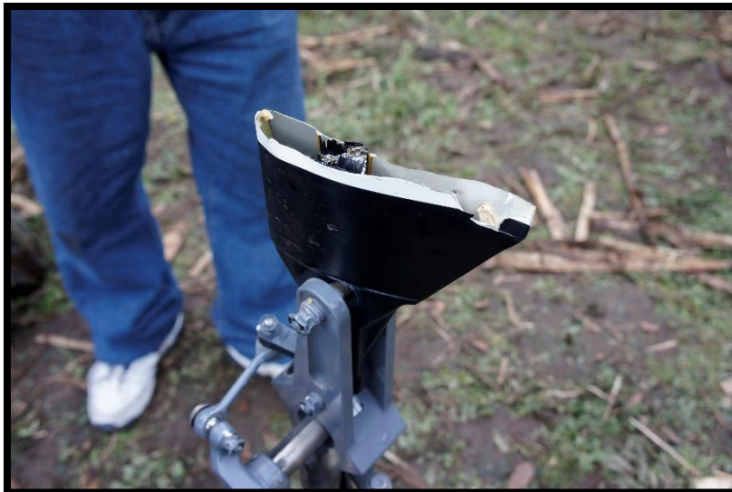
Fotografía No. 06 Vista de una de las palas fracturadas desde su raíz en el impacto.
