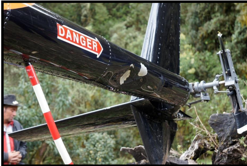
Fotografía No. 05 Vista de los impactos en el botalón de cola por las palas del rotor.
