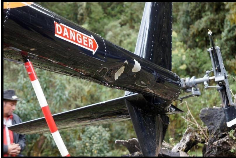
Fotografía No. 13 Daño al rotor de cola y el botalón.
