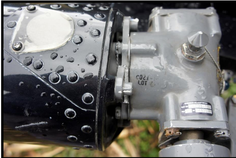
Fotografía No. 07 Vista de los daños a la caja de 90° del rotor de cola.
