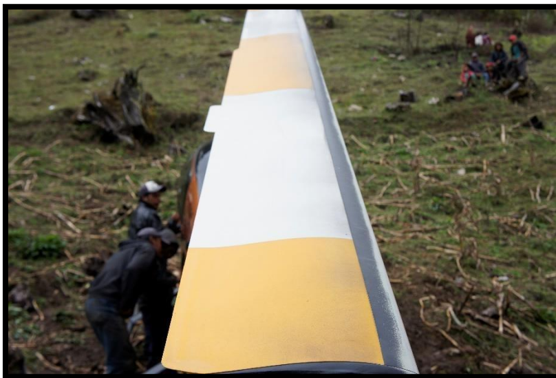
Fotografía No. 18 Pala del rotor principal sin daños aparentes.
