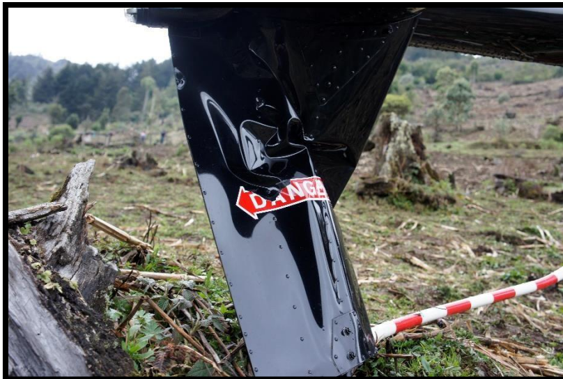
Fotografía No. 16 Vista inferior del daño al estabilizador vertical del botalón de cola.
